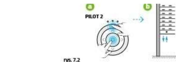
Innerhalb von **20 Sekunden** kann eine weitere Fernbedienung programmiert werden. Erfolgt **innerhalb dieser Zeit keine weitere Programmierung**, kehrt der Motor **automatisch in den Betriebsmodus** zurück.
