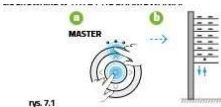
2. Auf der **neuen Fernbedienung ebenfalls STOP und HOCH** gedrückt halten, bis der Motor zwei kurze Bewegungen macht. Die zweite Fernbedienung wurde nun gespeichert.
